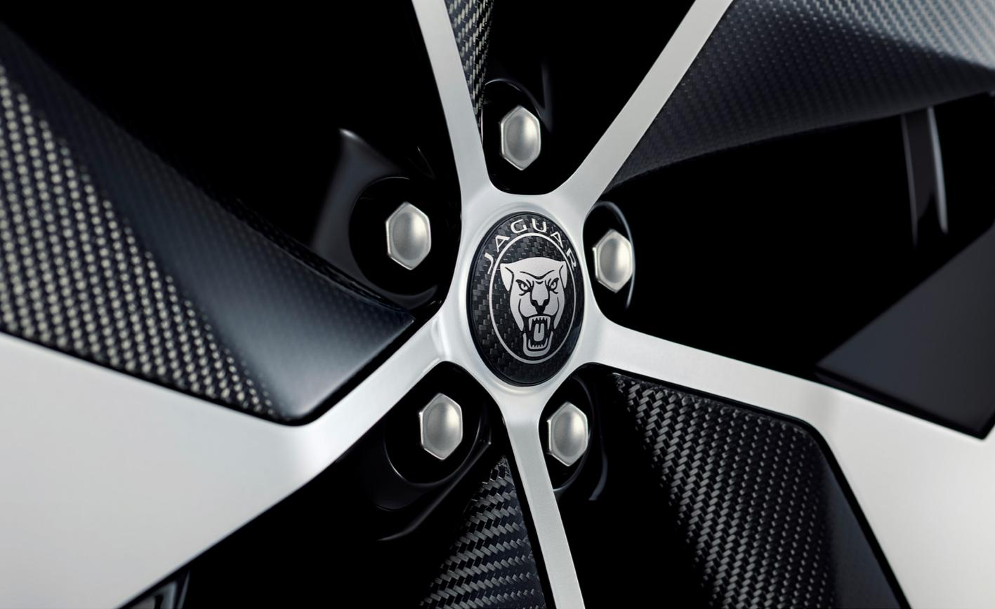
**Cache-moyeu en fibre de carbone**
